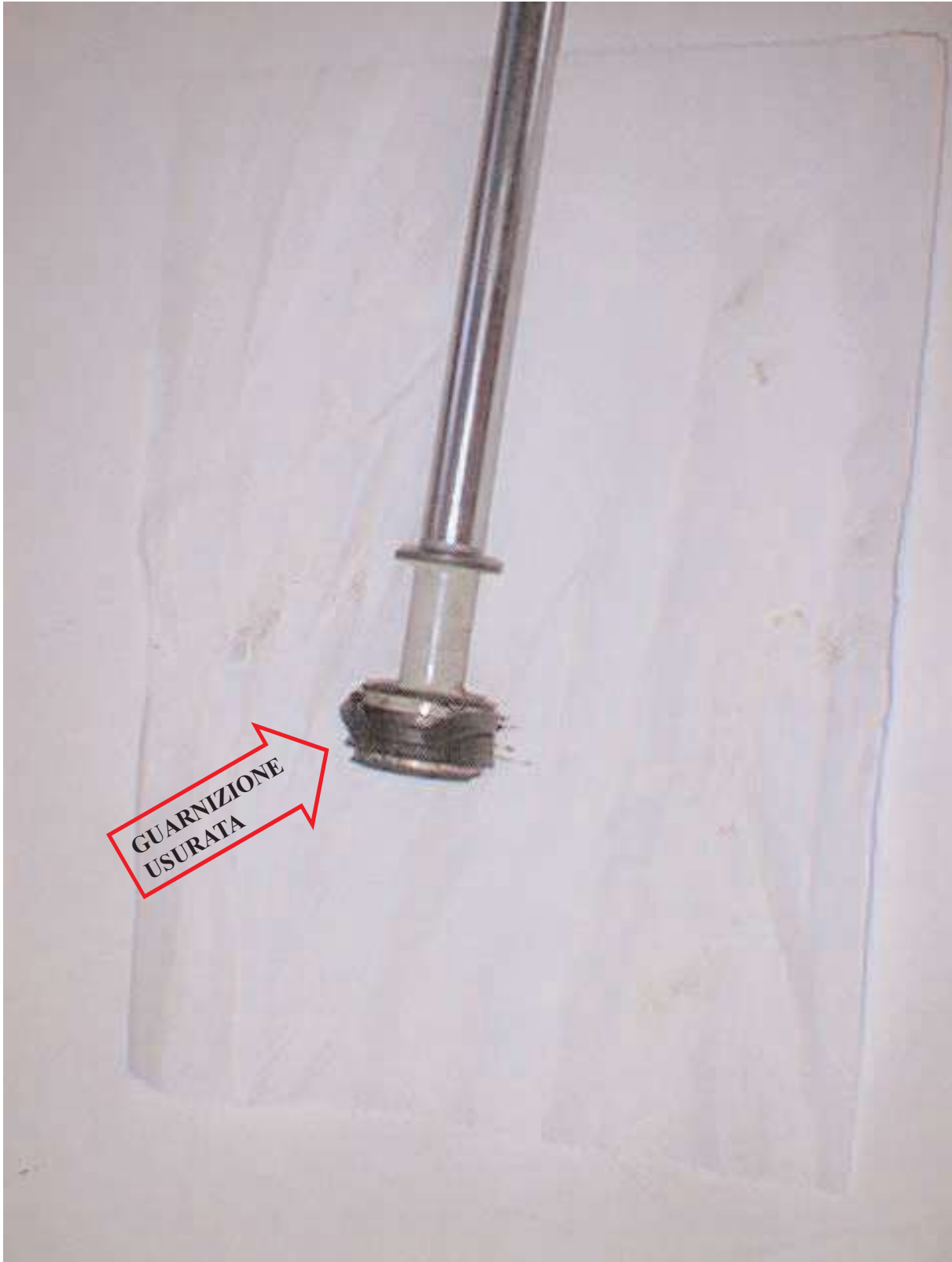
Particolare del pistone con guarnizione di tenuta usurata
