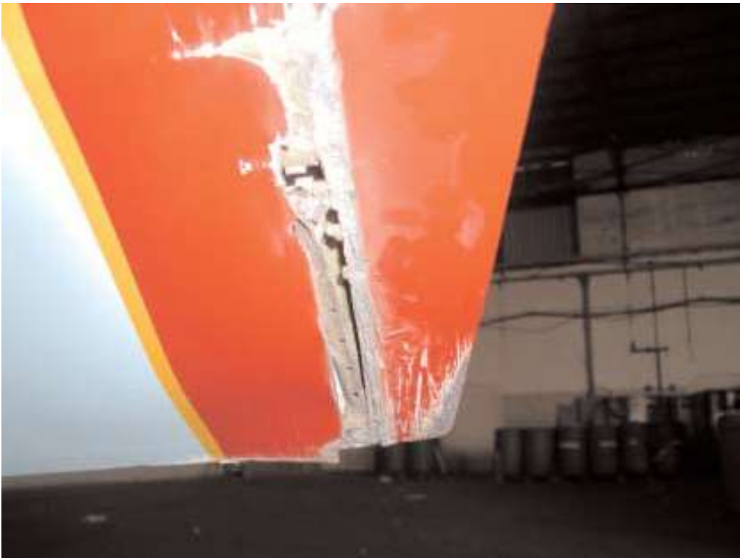
Particolare dell'alettone danneggiato
