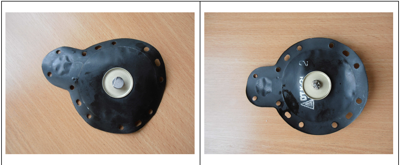
2 pav. Lėktuvo PZL-104 WILGA-35A (nacionalinis registracijos ženklas LY-AHJ) karbiuratoriaus K-14A membrana (vaizdai iš abiejų pusių).
