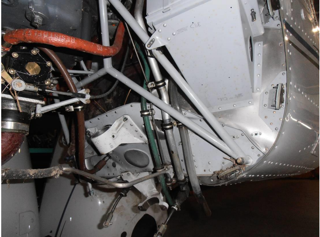
6 pav. Atgal pasislinkę ir užlinkę priekinės važiuoklės atramos tvirtinimo mazgai.
