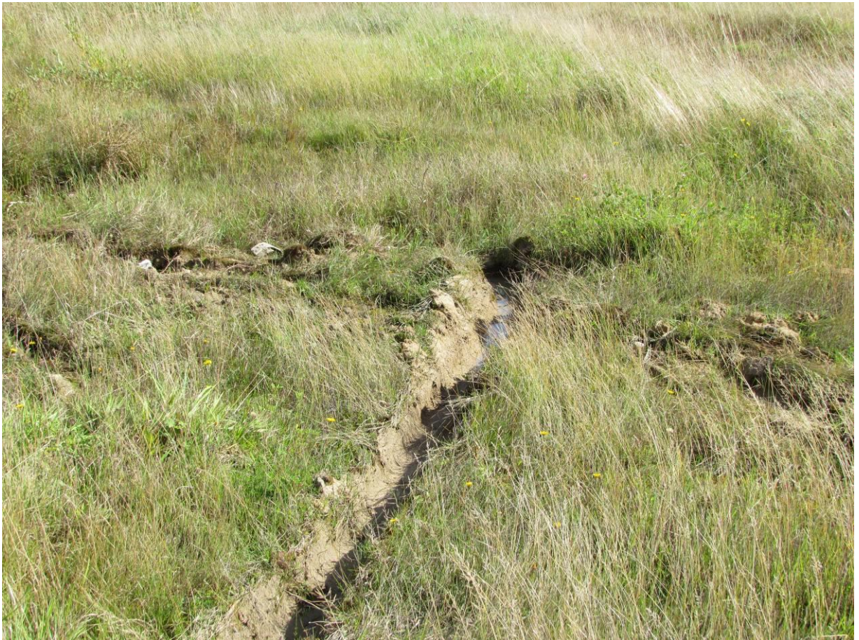
1 pav. Priekinio rato palikta vėžė lėktuvui išriedėjus už KTT ribų.
