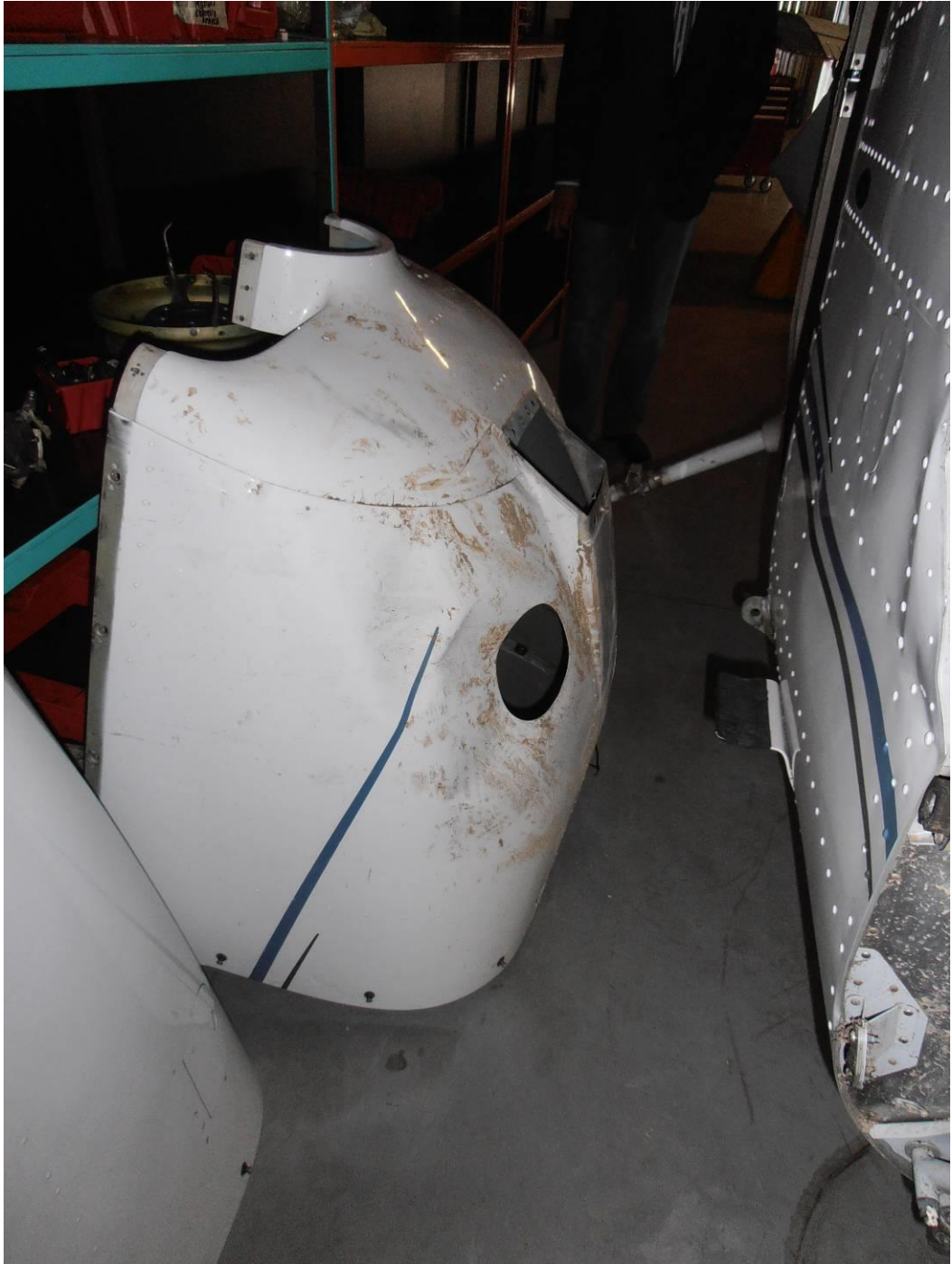
5 pav. Aplankstytas apatinis variklio kapotas.
