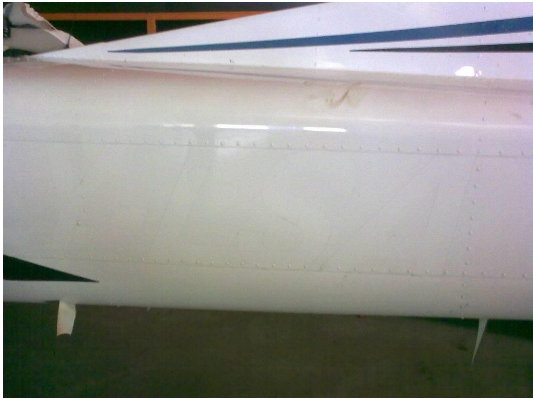
4 pav. Nacionalinių registracijos ženklų pėdsakai kairiosios liemens pusės gale.
