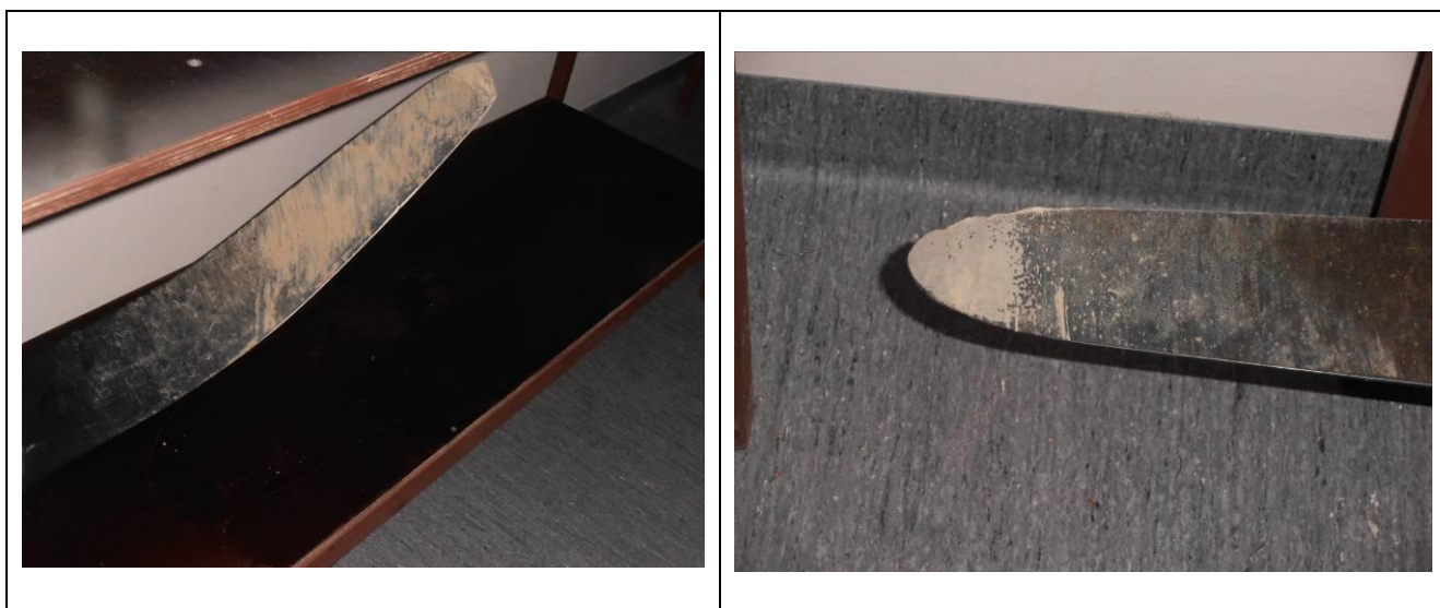
8 pav. Pažeisti propelerio menčių galai.
