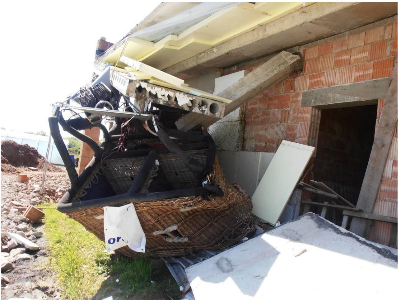
4 pav. Baliono krepšio pažeidimai. Dešinėje krepšio pusėje matyti deformuotas ir sutrūkęs jo kampas. Šiuo kampu krepšys trenkėsi į terasos stogą laikančią koloną.
