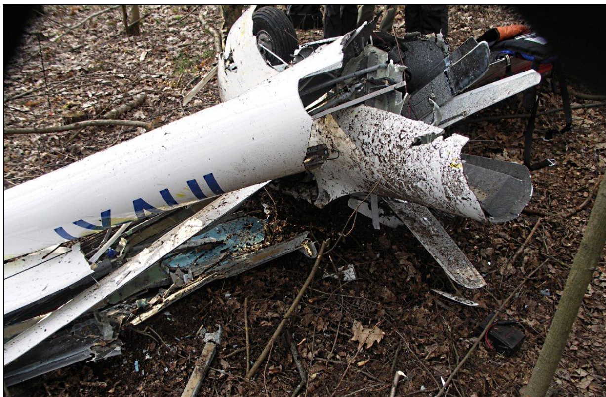
19 – Rozbity szybowiec – fragment odłamanej belki ogonowej, nasadowa część prawego skrzydła i środkowa część kadłuba; widok od tyłu.
