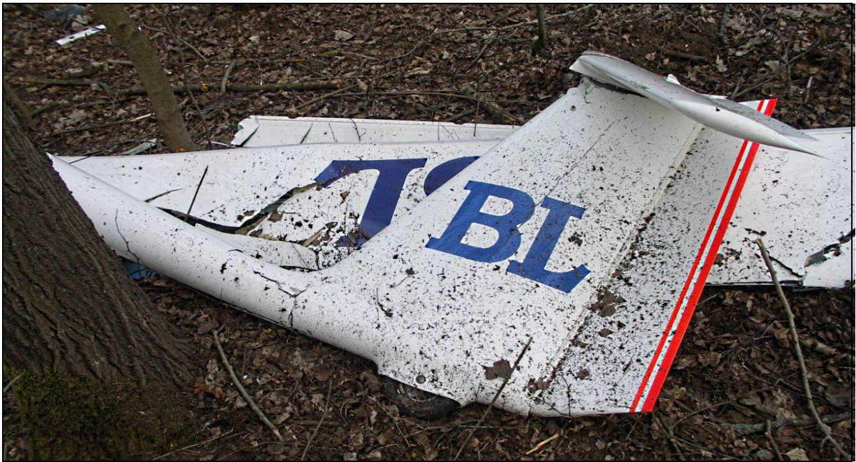
11 – Rozbity szybowiec – odłamana belka kadłuba z usterzeniem i prawe skrzydło; widok od przodu.
