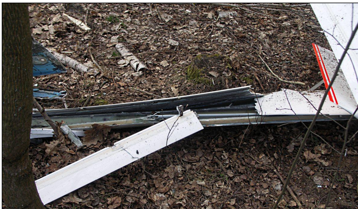
16 – Rozbity szybowiec – środkowa część prawego skrzydła; widok od tyłu.
