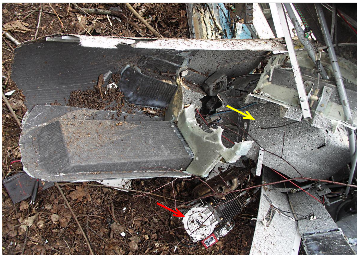
20 – Rozbity szybowiec – środkowa część kadłuba; widok od tyłu. Strzałką czerwoną wskazany silnik, żółtą – zniszczony zbiornik paliwa (odlaminowany od konstrukcji kadłuba).
