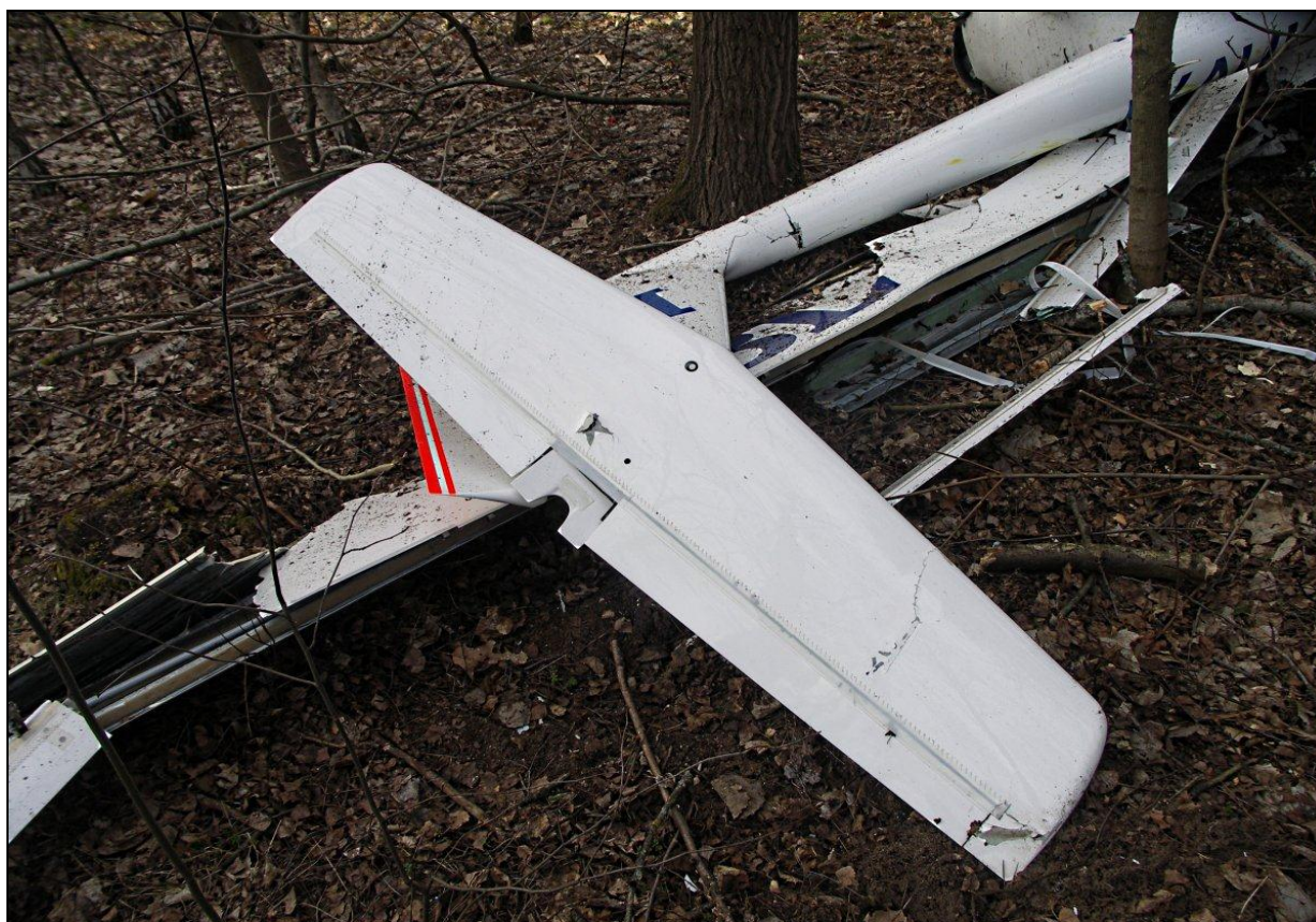
17 – Rozbity szybowiec – odłamana belka kadłuba z usterzeniem i prawe skrzydło; widok od tyłu.
