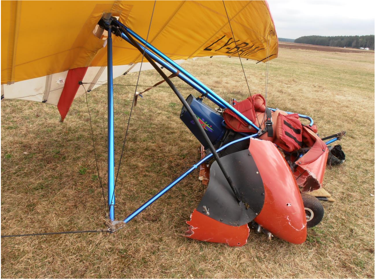
7 pav. Skraidyklės valdymo trapecija. Matosi deformuotas skersinis vamzdis.
