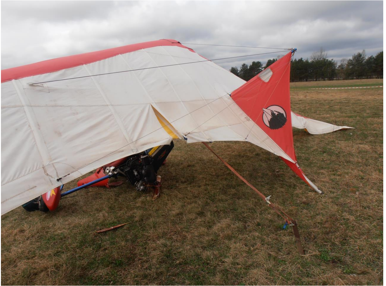
5 pav. Įplyšusi kairiosios sparno pusės viršutinė apsiuva.
