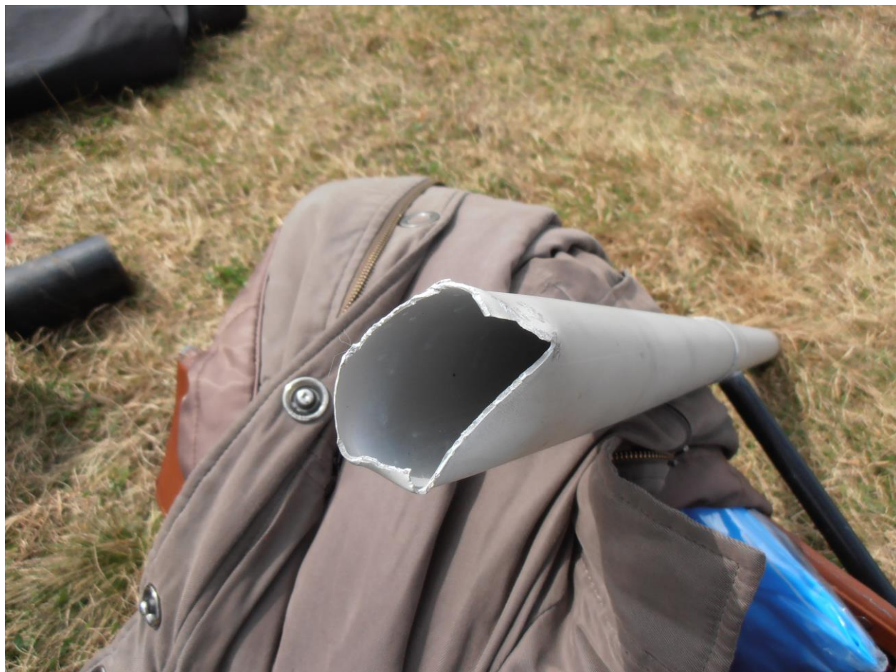
3 pav. Nulūžęs dešinės sparno pusės karkaso vamzdžio galas.
