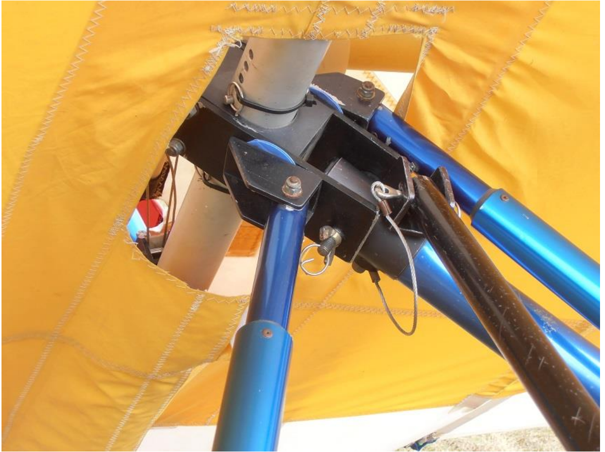
10 pav. Šarnyrinis skraidyklės sparno, valdymo trapecijos ir vežimėlio tvirtinimo mazgas po avarijos.
