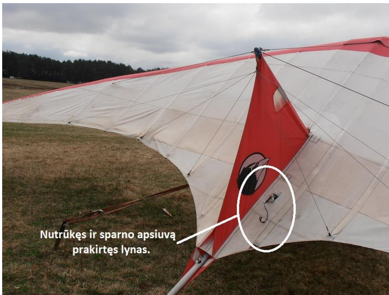
4 pav. Nutrūkęs ir sparno apsiuvoje įstrigęs dešinės pagrindinės važiuoklės atramos tvirtinimo lynas.
