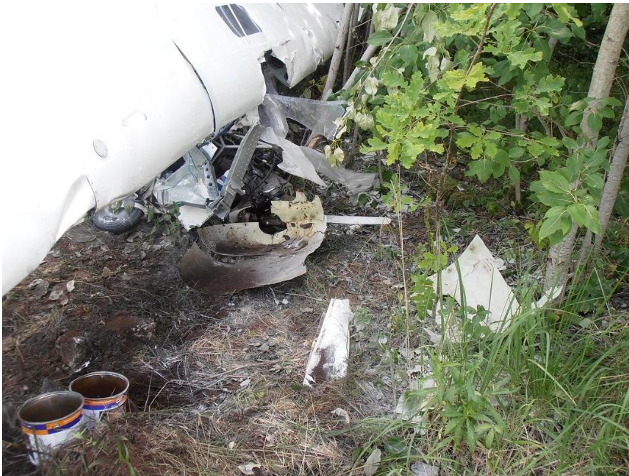
4 pav. Deformuotas liemens priekis.
