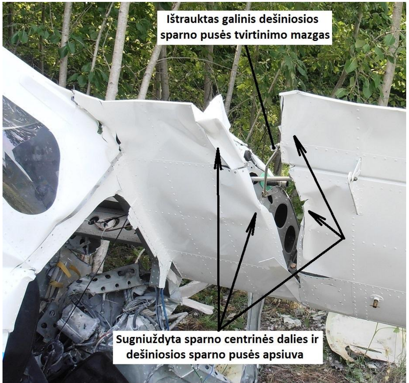
10 pav. Sugniuždyta apsiuva dešinėsios sparno pusės tvirtinimo prie liemens zonoje.
