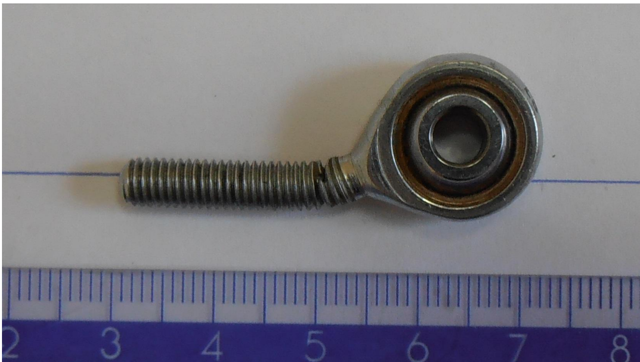
14 pav. Nulūžęs antgalis sudėtas sutapatinant lūžio plokštumas.
