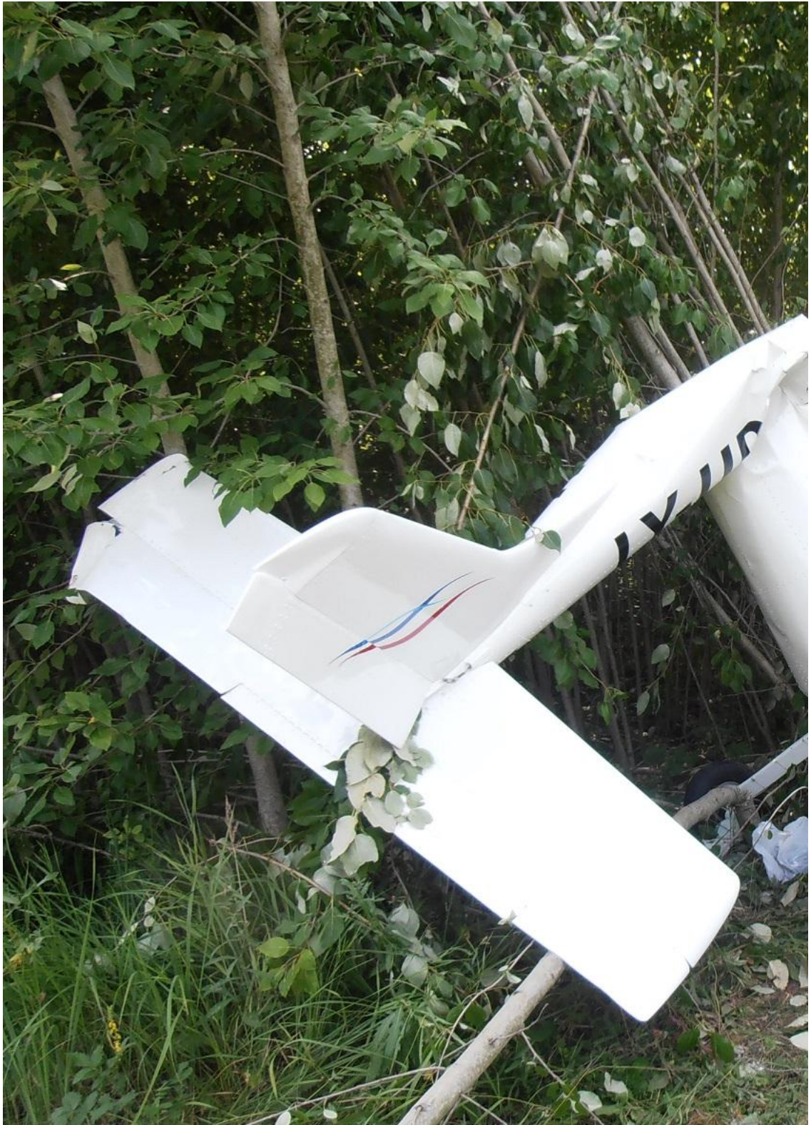
8 pav. Avariją patyrusio lėktuvo kilis ir stabilizatorius.
