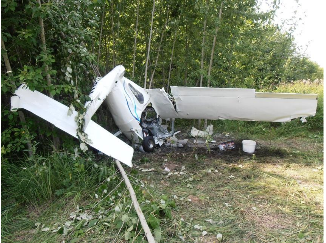
6 pav. Dešinėsios sparno pusės ir liemens pažeidimai.
