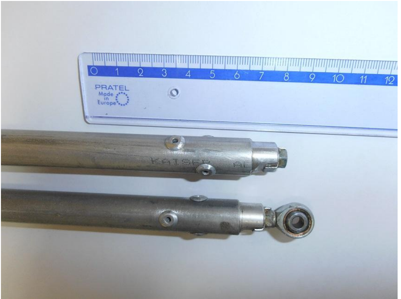
12 pav. Valdymo traukė su nulūžusiu antgaliu (viršuje) ir nepažeista valdymo traukė (apačioje).
