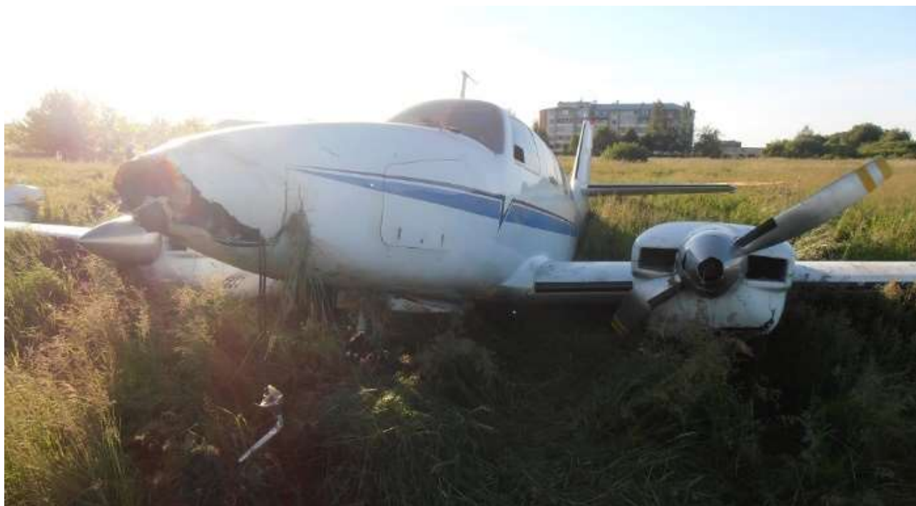
6 pav. Orlaivis „VK-9“ avarijos vietoje su sulaužytu priekiniu ir kairiojo variklio aptakais
