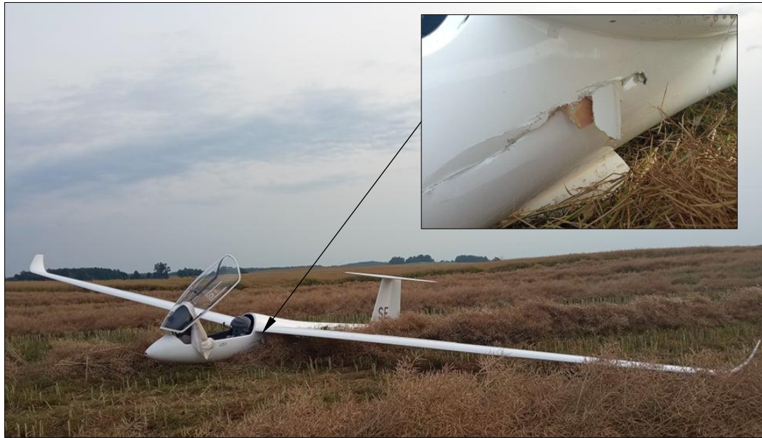
7 pav. Sklandytuvas SE su liemens pažeidimu ir įstrigusia sklandytuvo VM stabilizatoriaus nuolauža nusileidimo vietoje
