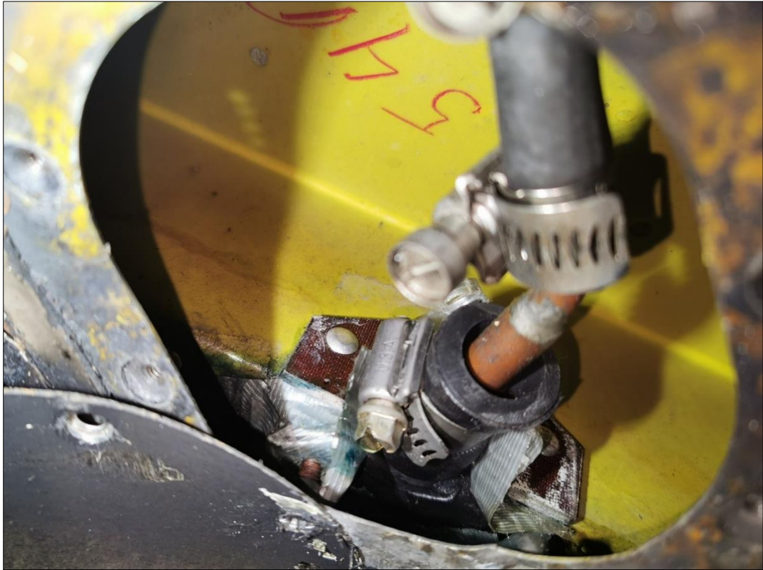
9 pav. Kairiojo sparno papildomo degalų bako prijungimas
