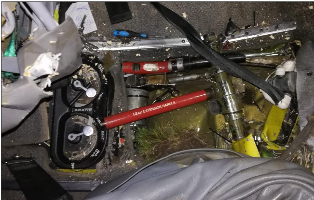
11 pav. Avarinės važiuoklės išleidimo sistemos rankena
