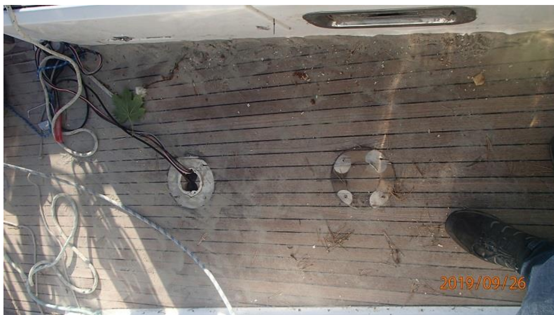
Zdjęcie nr 12. Ślady po wkrętach mocujących stolik kokpitowy (fot. M. Cesnauskis).
