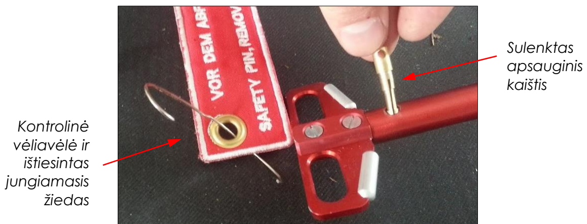
15 pav. Parašiuo aktyvavimo rankenėlė ir sulenktas apsauginis kaištis
