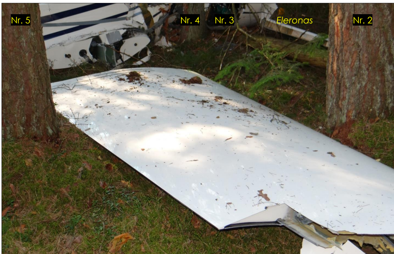
11 pav. Atsiskyręs dešinysis sparnas, gulintis tarp pušų kamienų
