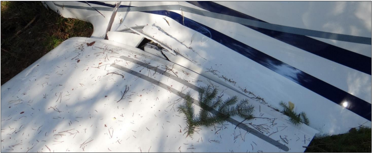
10 pav. Pasislinkęs kairysis sparnas
