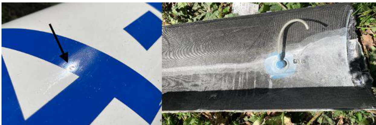
Рис. 20. Заклеенное отверстие приемника статического давления
