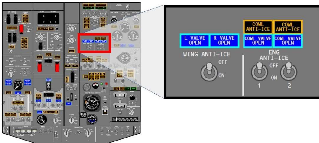
4 pav. Variklio oro ėmiklio gaubto apsaugos nuo apledėjimo sistemos jungiklių vieta viršutiniame skrydžio valdymo pulte P5 (paveikslėlio autorinės teisės © Boeing; atkurta su leidimu, modifikuota)
