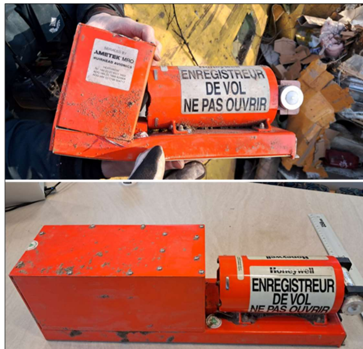
7 pav. Savirašiai suradus avarijos vietoje: viršuje pavaizduotas CVR, apačioje – FDR (šaltinis ir autorinės teisės © TAIIID)
