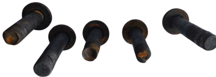
10 pav. Tvirtinimo varžtai su rūdžių požymiais (šaltinis: AAU)
