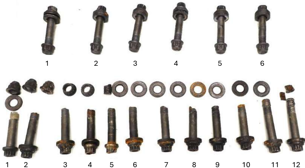
12 pav. Ratų tvirtinimo detalės – 6 nepažeisti varžtai viršuje ir 12 lūžusių varžtų apačioje (šaltinis: „Collins Aerospace“)
