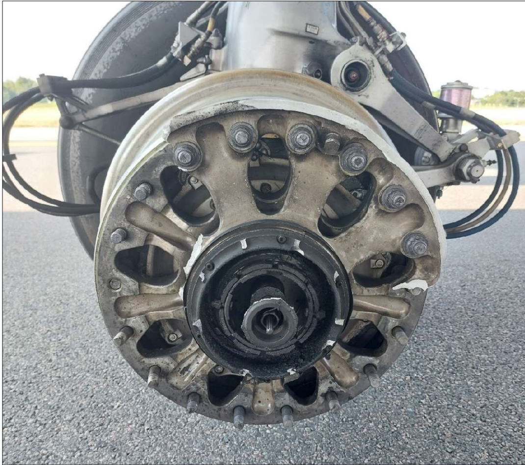
8 pav. Neatsiskyrusi pagrindinės važiuoklės rato Nr. 2 dalis (šaltinis: STS)
