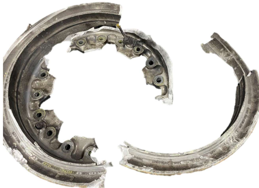
11 pav. Lūžusios išorinės rato pusės dalys (šaltinis: NTSB)
