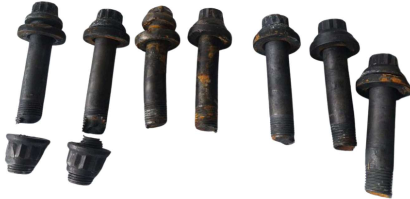
9 pav. Tvirtinimo varžtai su rūdžių požymiais (šaltinis: AAU)
