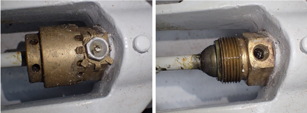
Fotos 4 und 5: Vordere Verbindung der hinteren Steuerstange mit dem Steuerknüppel, mit und ohne Überwurfmutter
