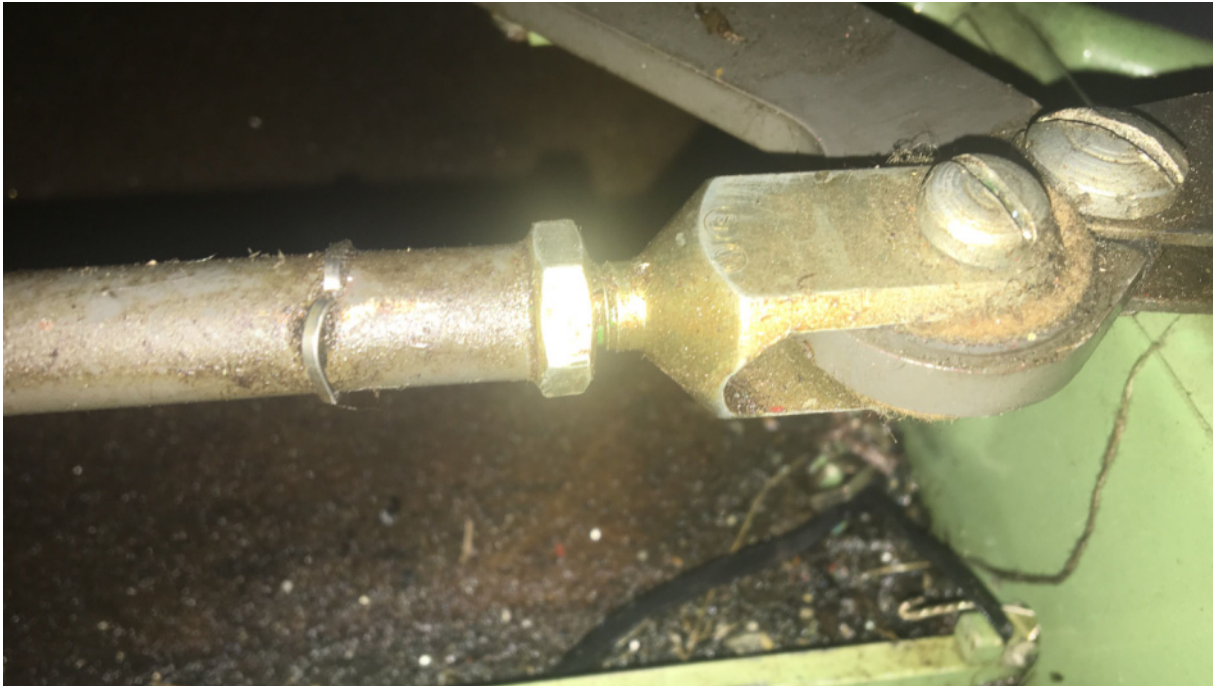
Foto 6: Beispiel für die zusätzliche Sicherung (Splint) bei einem anderen Flugzeug des Musters Fw44J „Stieglitz“ Quelle: Flugzeughalter einer Fw44J „Stieglitz“
