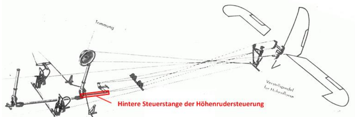
Abb. 1: Darstellung der Höhenrudersteuerung
